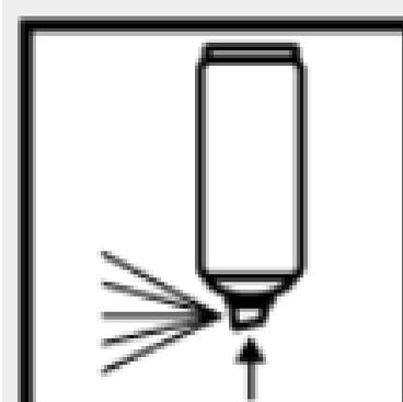
6. Очистите распылительную насадку. Для этого переверните баллон и удерживайте нажатой насадку до тех пор, пока из сопла не начнет выходить один газ без продукта.
