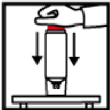
3. Поместите баллон на ровную горизонтальную поверхность и надавите на клапан с достаточным усилием для активации продукта.
